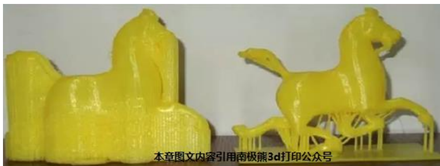
图 1-4 去除支撑材料前的打印作品(左)以及去除支撑材料后的作品(右)
