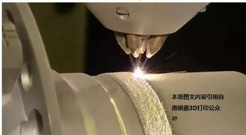
图 1-59 LENS 技术对破损的零件进行修复
