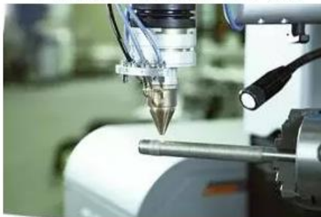
图 1-60 在传感器表面制造硬合金熔覆层
