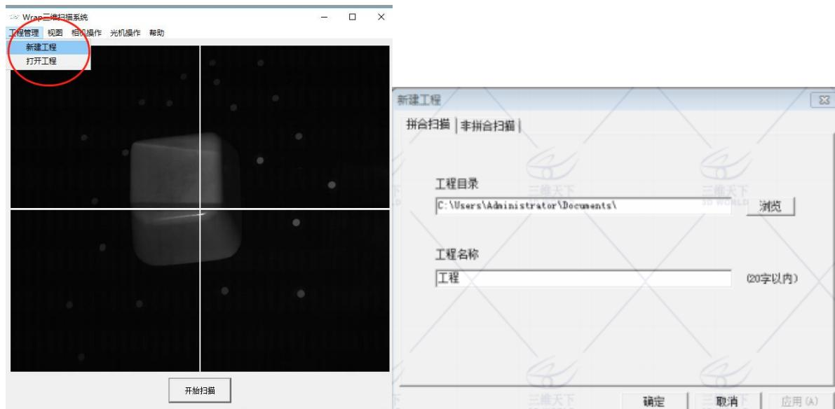
调整扫描距离，点击光机操作—投影十字，调整三脚架高度，使两个十字尽量重合并在工件上。
