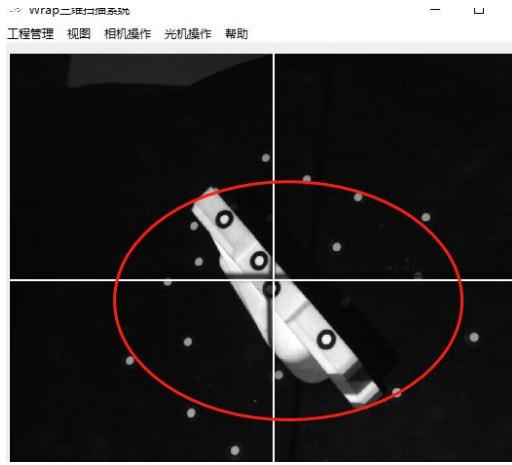
设置相机参数，调整曝光、增益、亮度、对比度的参数来设置相机采集亮度。
