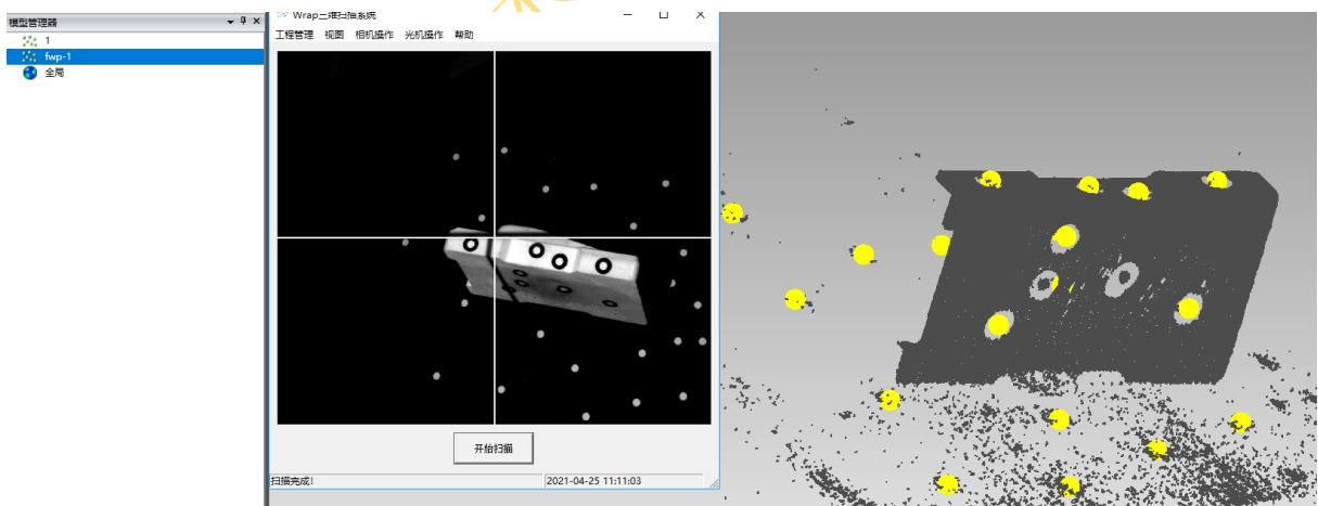
扫描结果会在 Wrap 图像显示框中显示三维点云数据。
